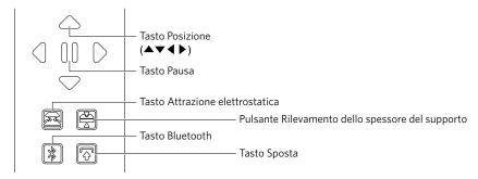
Tasto Posizione: utilizzare questo tasto per spostare manualmente il carrello portastrumenti e la posizione del
